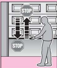
Weisen Sie alle Personen, die die Toranlage benutzen, in die ordnungsgemäße und sichere Bedienung des Garagentorantriebes ein. Demonstrieren und testen Sie die mechanische Entriegelung sowie den Sicherheitsrücklauf. **Halten Sie dazu das Tor während des Torzulaufes mit beiden Händen an; die Toranlage sollte sanft abschalten und den Sicherheitsrücklauf einleiten. Ebenso muss während des Torauflaufes die Toranlage sanft abschalten und das Tor stoppen.**
