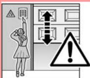
**Festinstallierte Steuerungsgeräte (wie Taster etc.), sind in der Sichtweite des Tores zu montieren, aber entfernt von sich bewegenden Teilen und in einer Höhe von mindestens 1,5 m.**
