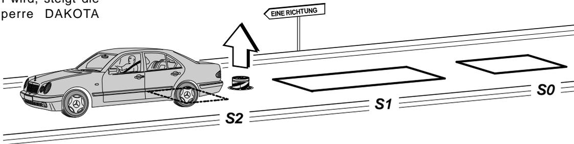
Die Spiralen **S1** und **S2** führen auch eine Sicherheitsfunktion aus, da sie das Aufsteigen des DAKOTA verhindern, so lange ein Fahrzeug auf ihnen steht.
