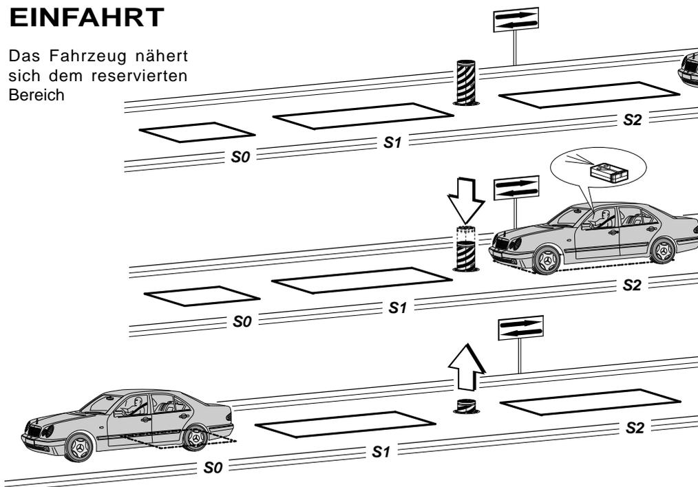
Sobald das Fahrzeug auf die in den Boden eingelassene Spirale **S2** fährt, wird das Absinken des DAKOTA nur nach dem Empfang eines Erkennungssignals befähigt. Falls die Parkplatzsperre wieder aufsteigen sollte, ist es zum erneuten Absenken derselben erforderlich, wieder auf die Spirale **S1** zu fahren und das Erkennungssignal zu aktivieren.
