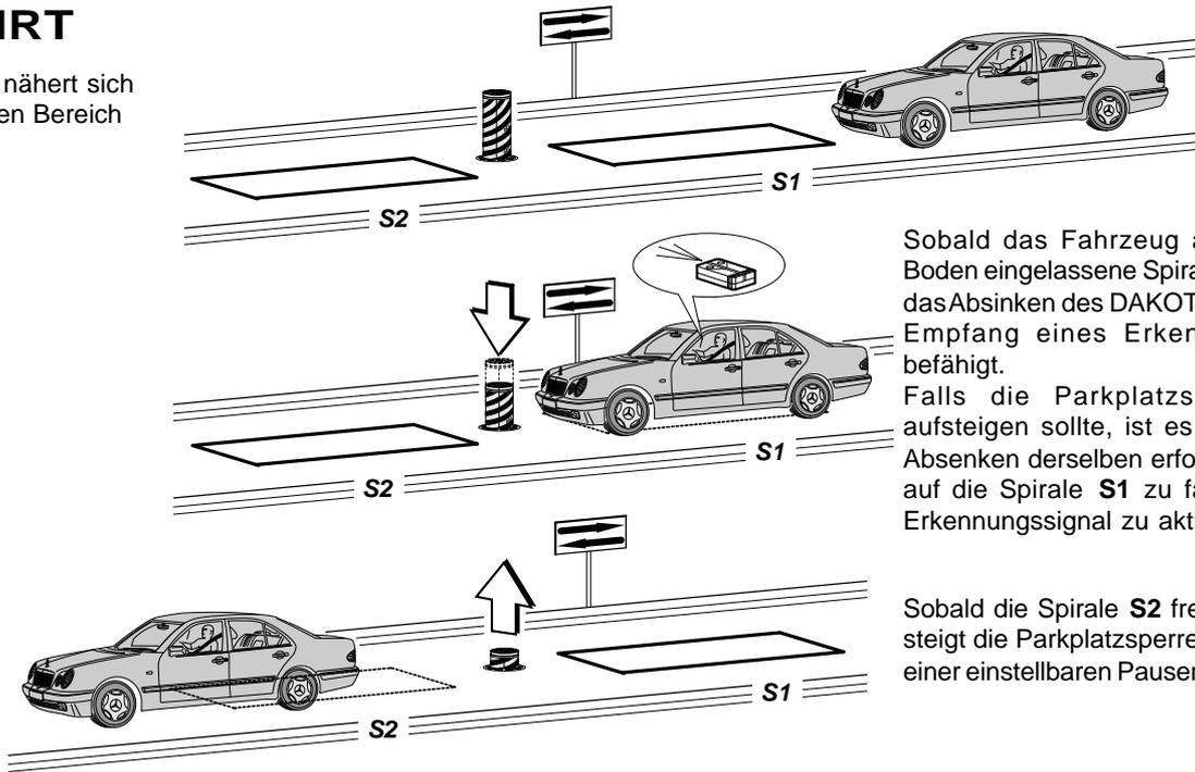
Sobald das Fahrzeug auf die in den Boden eingelassene Spirale **S1** fährt, wird das Absinken des DAKOTA nur nach dem Empfang eines Erkennungssignals befähigt.
