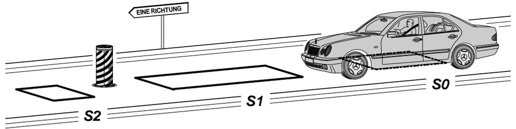
Sobald das Fahrzeug über die Spiralen **S0+S1** fährt, wird automatisch das Absinken der Parkplatzsperre DAKOTA gesteuert.
