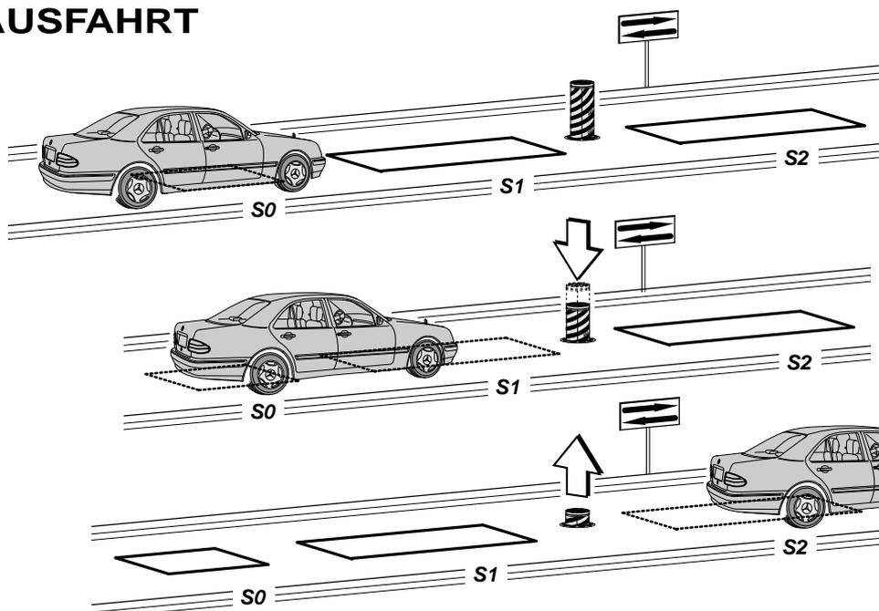
Sobald das Fahrzeug auf die in den Boden eingelassene Spirale **S0** fährt, wird die Parkplatzsperre DAKOTA befähigt, das Absenksignal von der Spirale **S1** zu empfangen.
