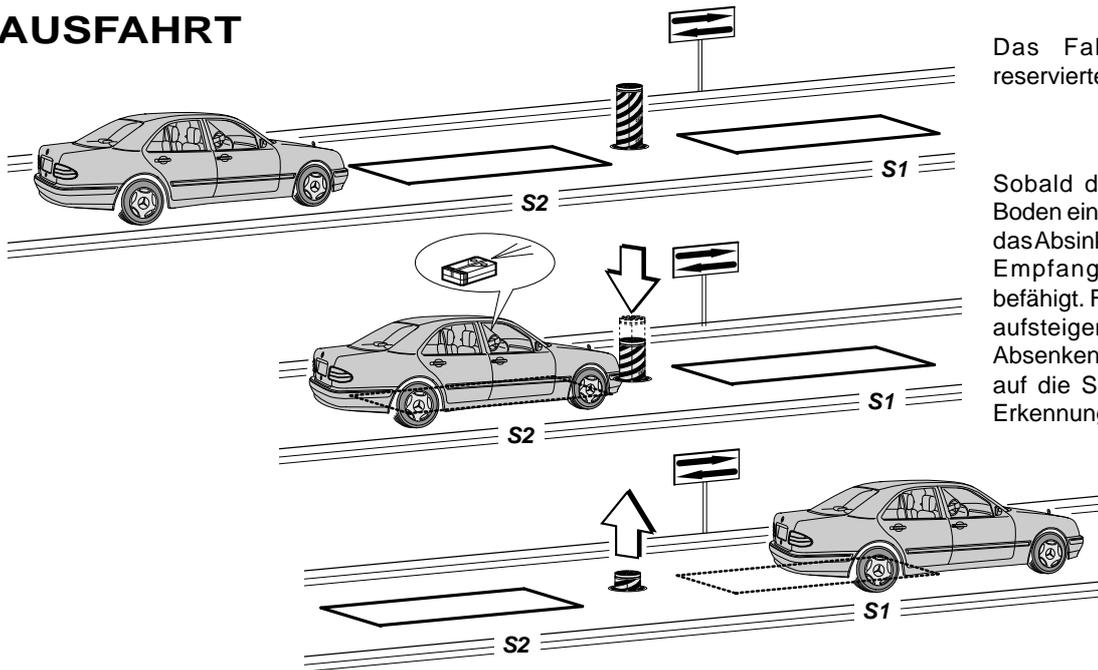
Sobald das Fahrzeug auf die in den Boden eingelassene Spirale **S2** fährt, wird das Absinken des DAKOTA nur nach dem Empfang eines Erkennungssignals befähigt. Falls die Parkplatzsperre wieder aufsteigen sollte, ist es zum erneuten Absenken derselben erforderlich, wieder auf die Spirale **S1** zu fahren und das Erkennungssignal zu aktivieren.
