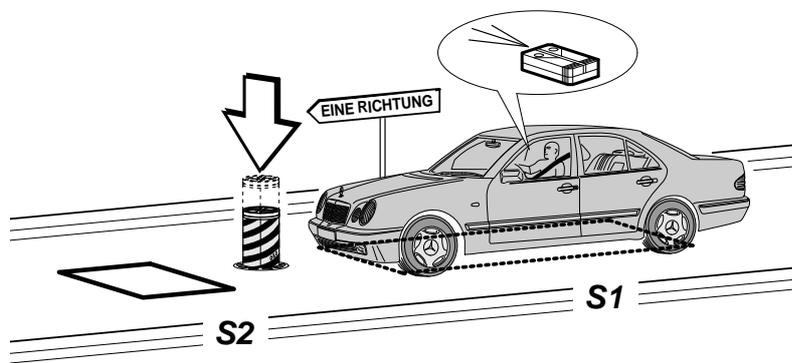
Sobald das Fahrzeug auf die in den Boden eingelassene Spirale **S1** fährt, wird das Absinken des DAKOTA nur nach dem Empfang eines Erkennungssignals befähigt. Falls die Parkplatzsperre wieder aufsteigen sollte, ist es zum erneuten Absinken derselben erforderlich, wieder auf die Spirale **S1** zu fahren und das Erkennungssignal zu aktivieren.
