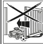
**⚠️ WARNUNG****Quetschgefahr an der Hauptschließkante und an den Nebenschließkanten**
