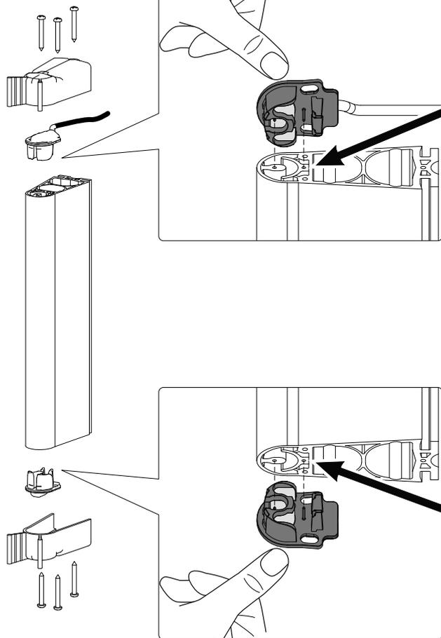
Das Anschlussstück senkrecht auf das Gummiprofil aufstecken. Darauf achten, dass die Kontaktnadeln in die Litze des Gummiprofils gesteckt werden. Die Zuleitung mit der Auswerteeinheit verbinden.
