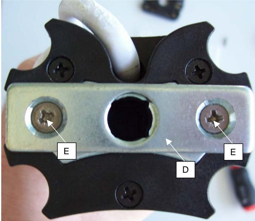
Die Aufnahme (D) der Schnellmontageplatte auf die Vierkantaufnahme legen und mit Hilfe der beiliegenden längeren Schrauben (E) befestigen.
